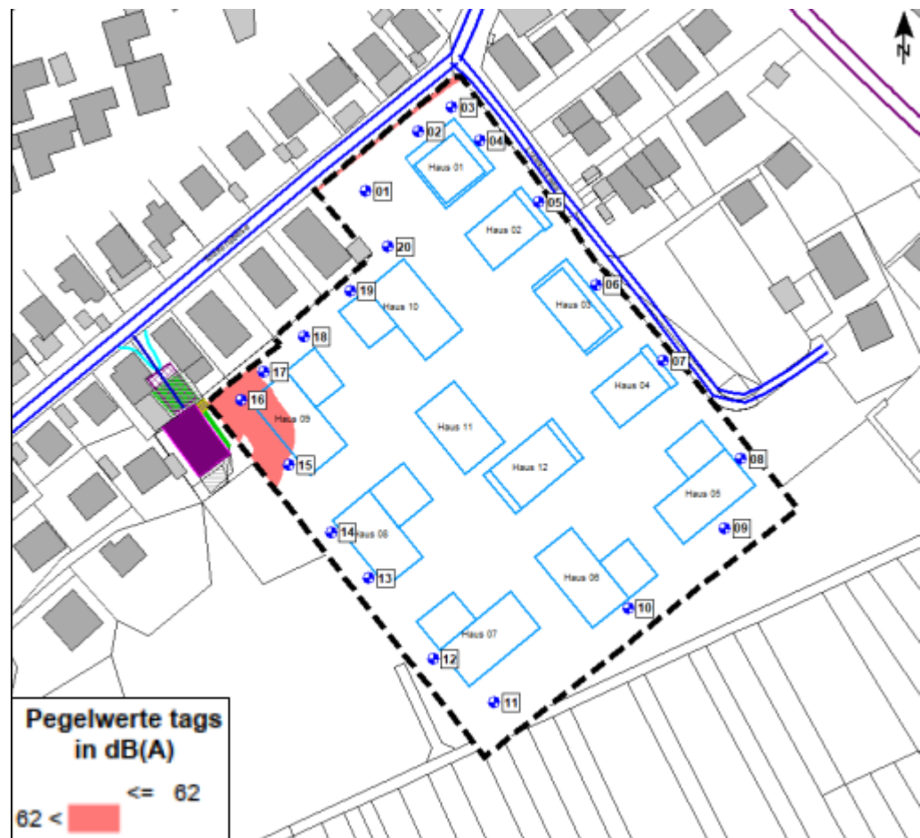
Abbildung 19 der schalltechnischen Untersuchung – Pegelbereiche > 62 dB(A) tags (Heine+Jud, 07.02.2024)
